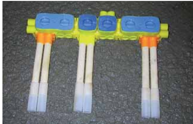
Figur 32. Ilægning af el efter støbning I enkeltarmerede betonvægge kan man vælge at ilægge rør og dåser i opsidens efter udstøbning og vibrering af betonen. I dobbeltarmerede vægge er denne praksis ikke mulig. Armeringsnettet i opsidens vil da ligge i vejen. I dobbeltarmerede vægge skal alle rør og dåser være anbragt og fastholdt inden udstøbning. Indbygning af en vandret dåserække som den viste i en dobbeltarmeret væg vil betyde overlappning af mange lodrette armeringsjern, hvilket der skal tages højde for i de statiske beregninger for væggen. Ved indstøbningen etableres udsparringer ved polykonmufferne. Det skal bemærkes, OPUS-dåserne her er samlet med korte (10 mm) afstandsstykker, som gør, at de senere monterede rammer stødes tæt mod hinanden. I dag anbefales 30 mm afstandsstykker (se figur 8).
