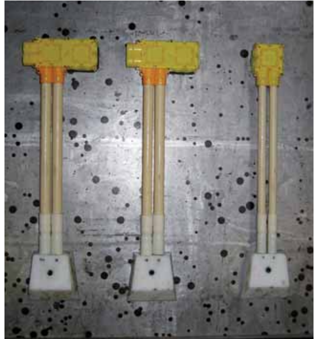
Figur 21. Som alternativ til polystyrenklodser er der her anvendt udsparingsklodser af kunststof med indbyggede magneter. Klodserne er koniske for at muliggøre af-formning på fabrikken. Klodserne genbruges.
