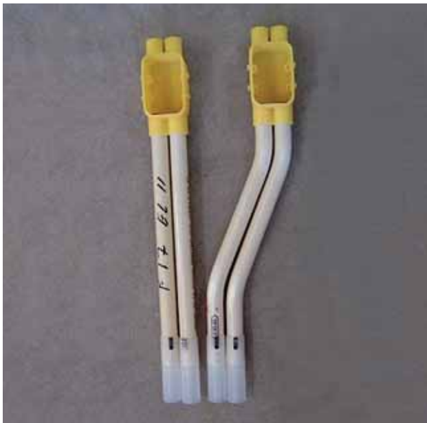
Figur 16. Inden selve elementproduktionen samles rør og dåser til færdige indstøbningsenheder, der er specielt tilpasset det enkelte elements geometri, armering og øvrige indstøbningsdele. Det er derfor generelt ikke muligt at ændre indstøbningsdelene, når elementerne er frigivet til produktion.
